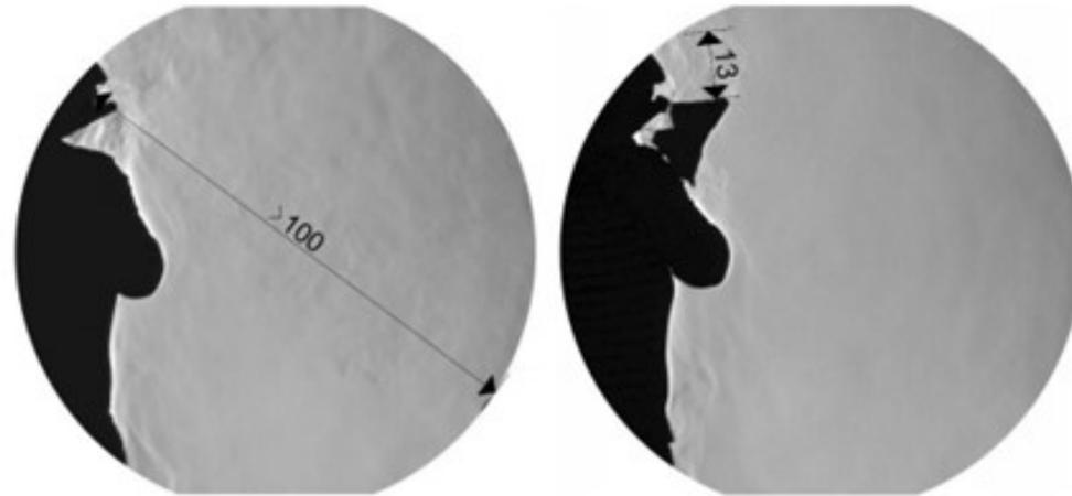
Illustration des charlottes ou bell covers avec à droite la visualisation par strioscopie de l'effet du dispositif sur le flux d'air
